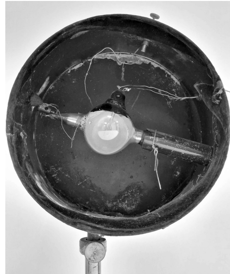
Photozelle von Elster und Geitel in einem Gehäuse
